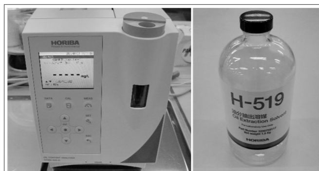
図3. 油分濃度計 OCMA-505-H (左図) 油分抽出溶媒 H-519 (右図)
