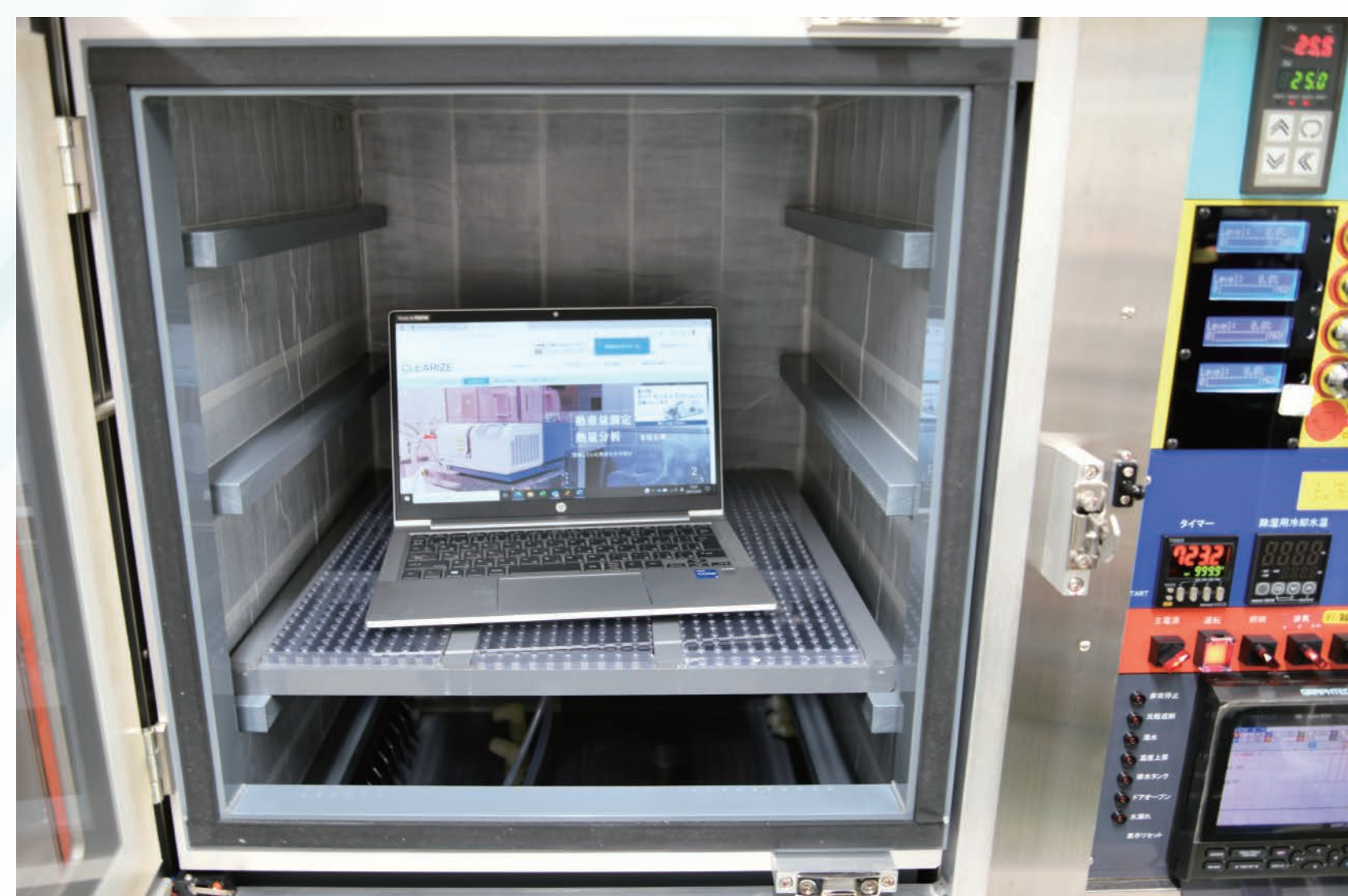
ガス腐食試験装置内イメージ
