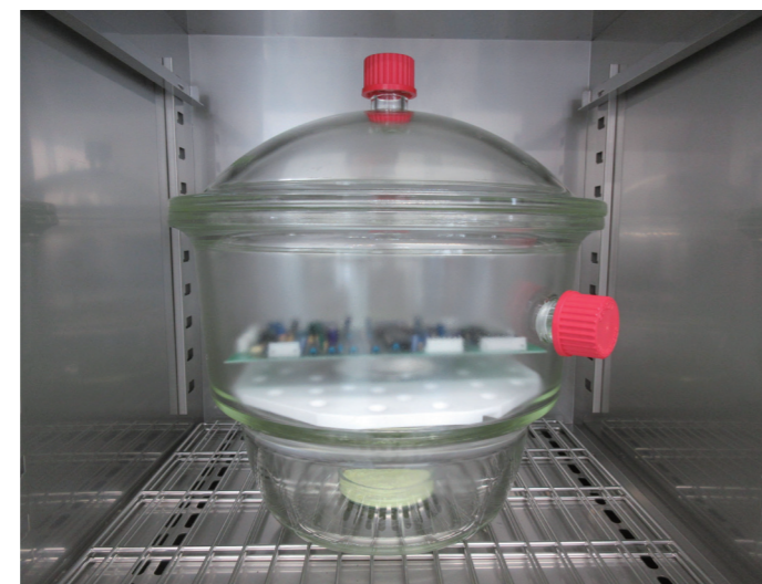
恒温槽でご要望の温度で暴露 (硫黄の蒸気圧又は実測値から暴露濃度算出)
