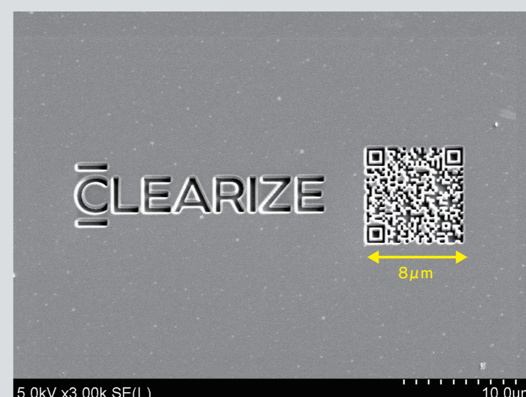
FIBによる任意形状加工後のSEM観察結果
