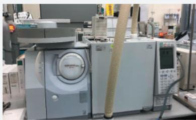
熱分解ガスクロマトグラフ質量分析装置
