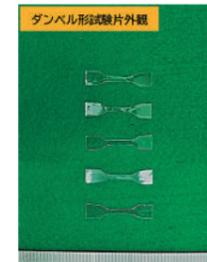
PEFC 電解質膜(ナフィオン膜)の高温高湿度下における引張試験
