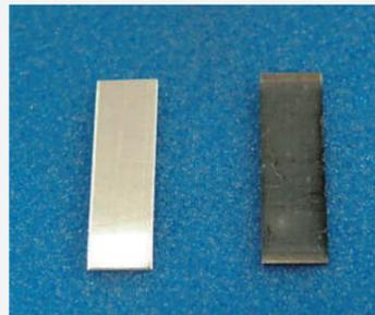
銀板の腐食試験前後
